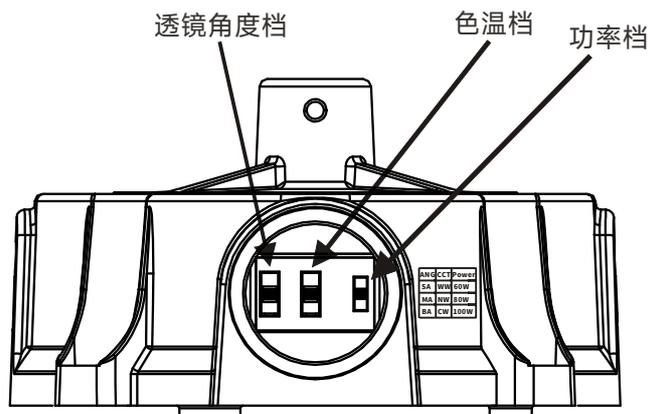
按图中所示，色温档由上至下：WW,NW,CW（暖光，混光，冷光）
