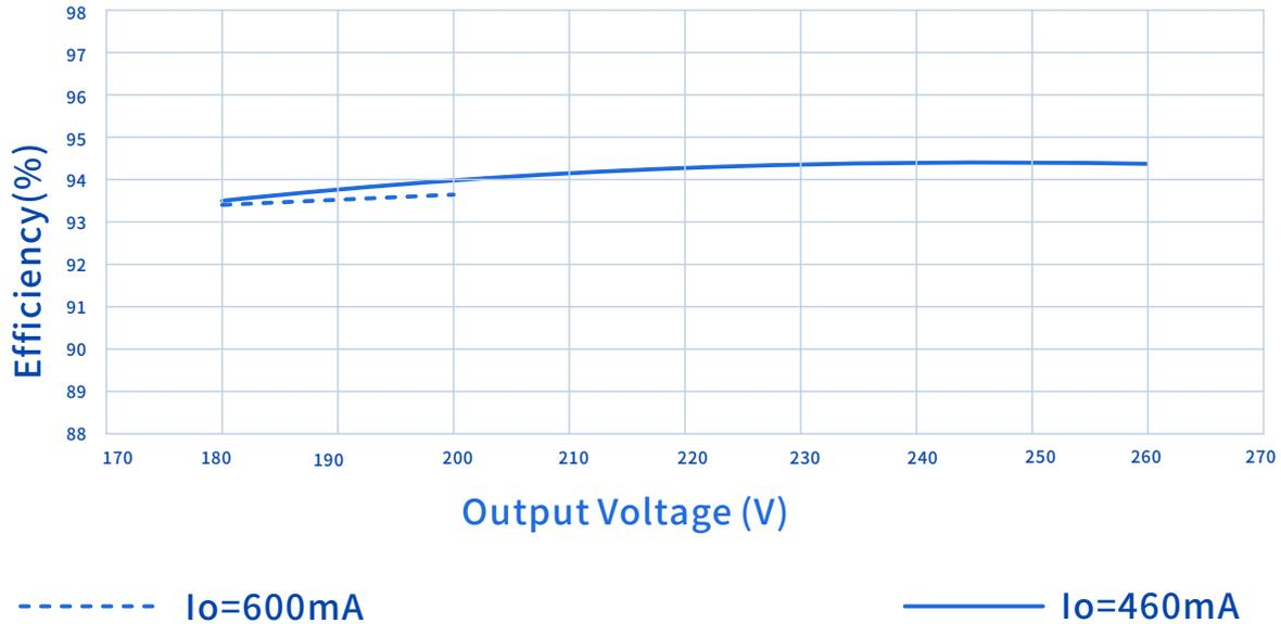
效率 Vs. 输出电压 ( $V_{in}=277V_{ac}$ )
