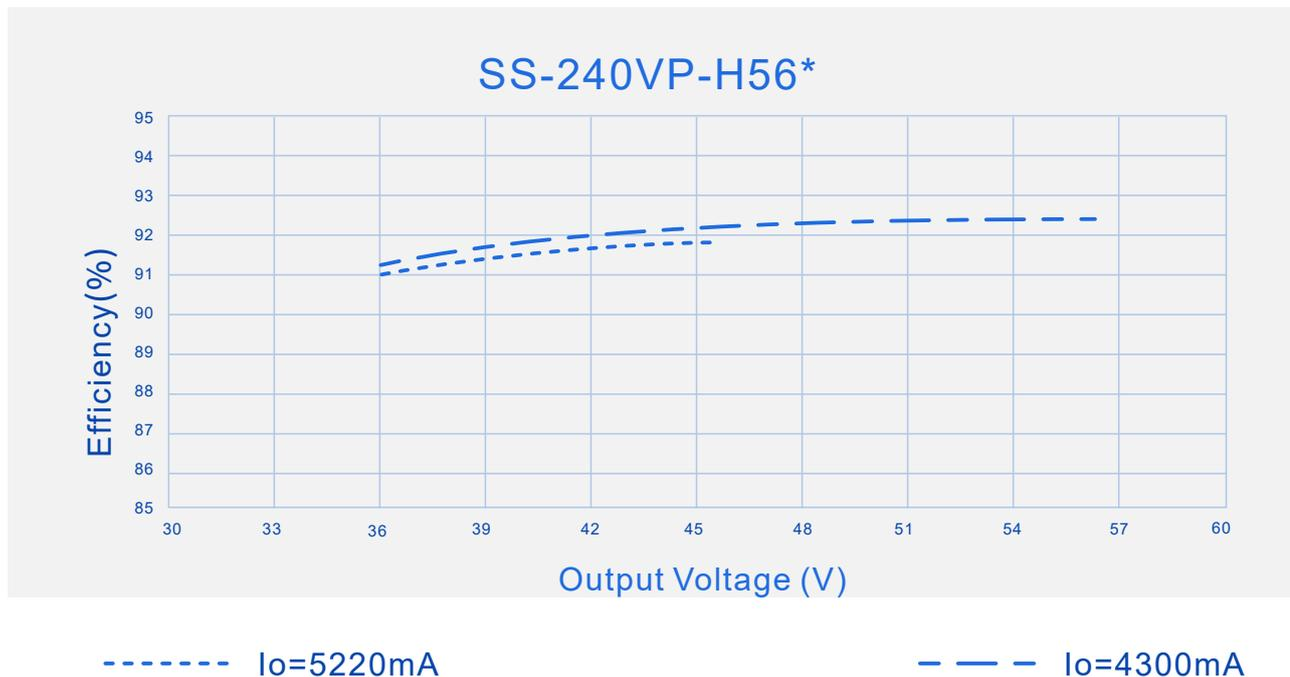
效率Vs.输出电压( $V_{in}=277Vac$ )
