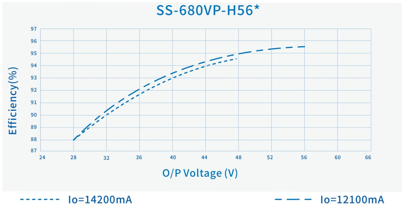
效率Vs. 输出( $V_{in}=120V_{ac}$ )
